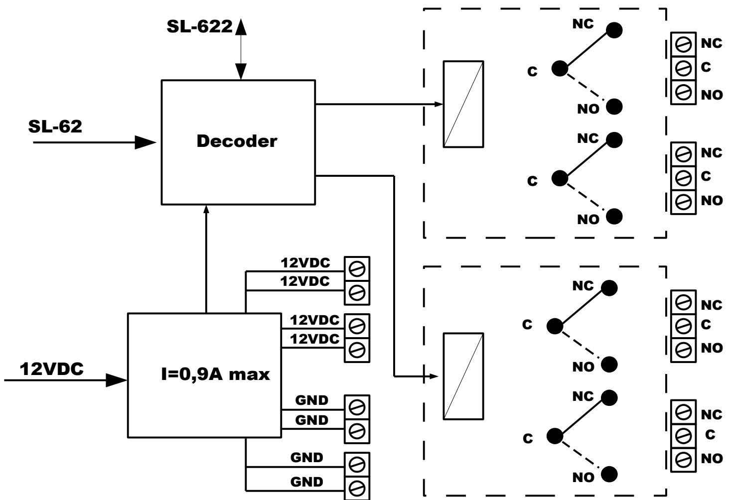
Gornji blok dijagram prikazuje elemente relejnog modula SL-621.
