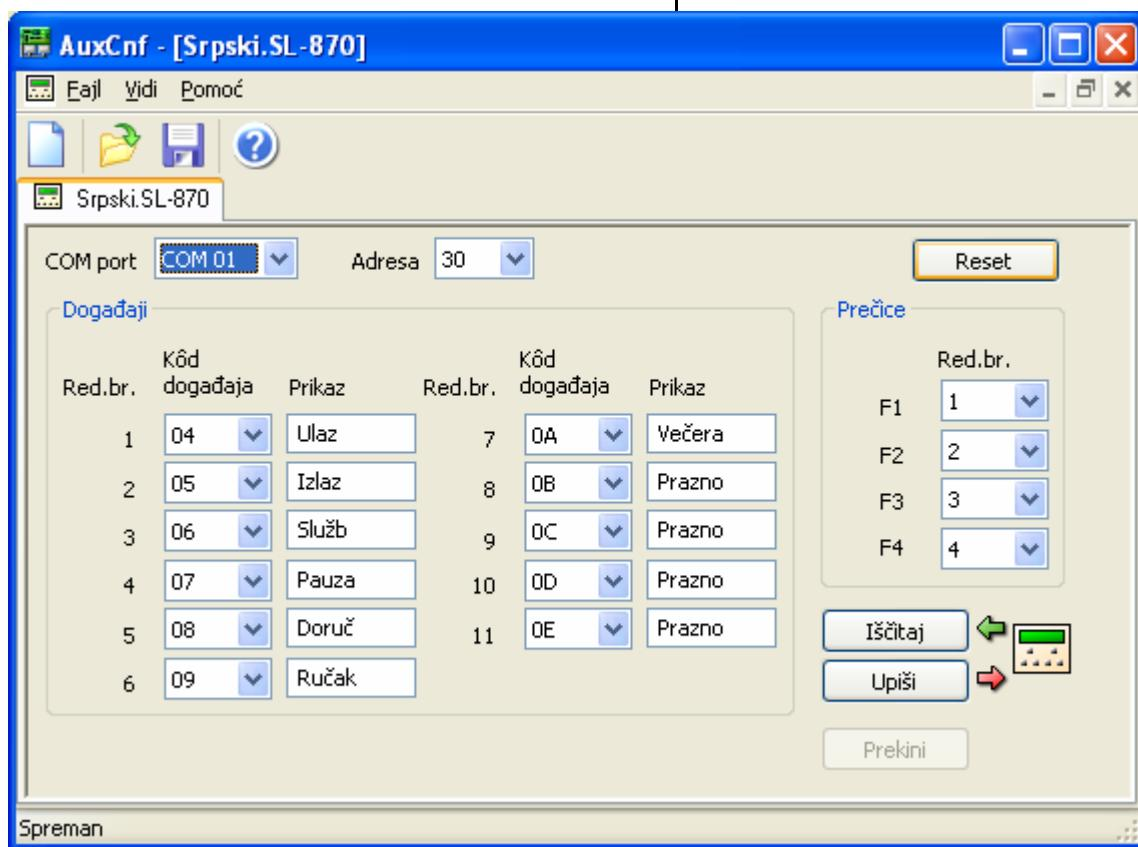
Master kontroler je konfigurisan za povezani AUX uređaj. U primeru je SL-84 konfigurisan za dva SL-870 termina.
